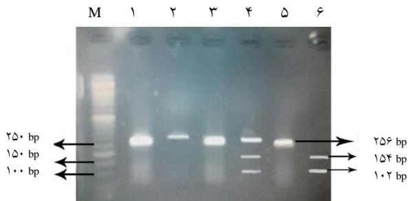
شکل ۲: نتایج الکتروفورز محصول PCR پس از RFLP برای پلی مورفیسم pLA<sub>1</sub>/pLA<sub>2</sub> روی ژل آگاروز ۳٪. چاهک M: مارکر ۵۰ bp؛ چاهک‌های ۱، ۳، ۵: محصول PCR قبل از RFLP؛ چاهک ۲: pLA<sub>1</sub>/pLA<sub>1</sub>، هموزیگوت سالم (۲۵۶ bp)؛ چاهک ۴: pLA<sub>1</sub>/pLA<sub>2</sub>، هتروزیگوت (۲۵۶ bp، ۱۵۴، ۱۰۲)؛ چاهک ۶: pLA<sub>2</sub>/pLA<sub>2</sub>، هموزیگوت بیمار (۱۵۴، ۱۰۲).
