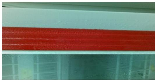
شکل ۱: وجود قطرات آب حاصل از بخار بر روی دیواره در و شبشه یخچال
