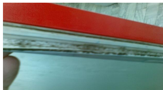
شکل ۳: انباشتگی گرد و خاک در لایه میانی نوار دور در یخچال‌ها
