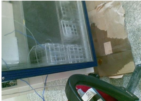
شکل ۲: تجمع قطرات آب بر روی شیشه در یخچال‌ها در اثر رطوبت
