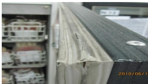
شکل ۵: خشک و شکننده شدن نوار دور در یخچال‌ها در اثر عوامل مختلف
