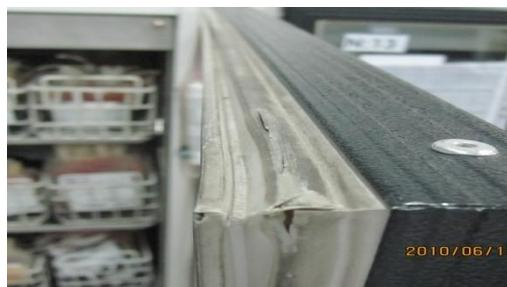
شکل ۵: خشک و شکننده شدن نوار دور در ینچال‌ها در اثر عوامل
