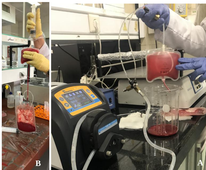
شکل ۲: قسمت A: شستشوی مکانیکی با کمک پمپ پریستالتیک، قسمت B: شستشوی دستی فیلتر به صورت معکوس
